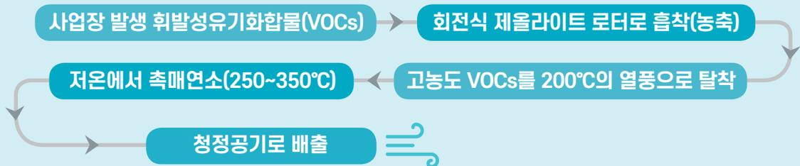
로터를 30~40°C(VOCs를 흡착할 수 있는 온도)로 냉각시켜 계속 사용하는 방식으로, 열교환기가 촉매층 상단에서 화염에 의해 500~600°C까지 상승하는 고온의 에너지를 촉매연소실의 연소 온도를 유지하는 역할과 탈착에 필요한 온도를 만들어 내는데 사용하므로써 에너지 소모를 최소화함.
